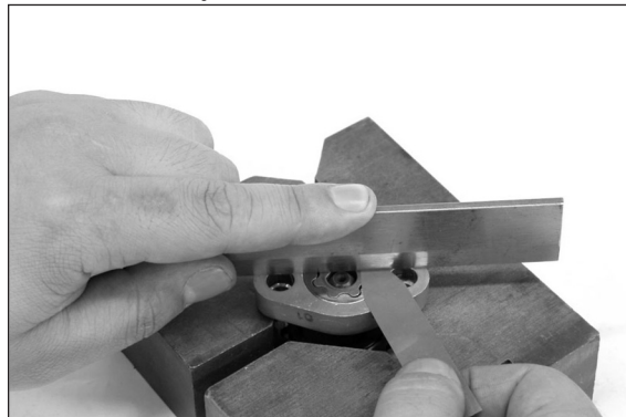
FOLGA ENTRE OS ROTORES E A FACE DA CARCAÇA DA BOMBA:
